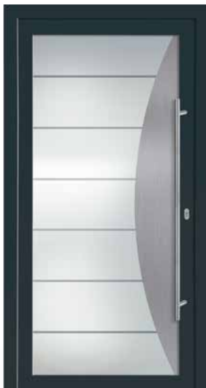
V-492 Ansicht A / DIN rechts Ganzglasfüllung 3-fach Glas Ug 1,7 bei 28 mm und Ug 1,1 bei 36 mm dunkle Streifen Klarglas, helle Flächen mattiert, bogenförmige Applikation in Edelstahloptik ■ Griff ZAE 6s, 1200 mm | PG 6
